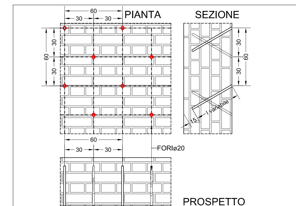
Dettaglio iniezione miscela leganti DETTAGLIO 02-Scala 1:20
